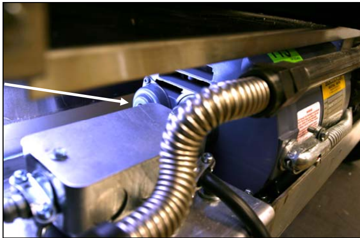
Διακόπτης επαναφοράς αντλίας φίλτρου (βέλος)
